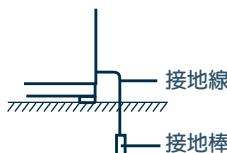
注意：絕對不可接在瓦斯管、自來水管、電話或避雷針的接地線。（此為法令所禁止）
