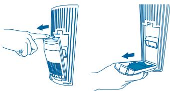
2. 將棉絮濾網向下推取出，再放置於水中清洗。
