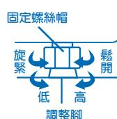
2. 水平儀氣泡位置於中心點時，請鬆開固定螺絲帽，轉動調整腳至氣泡位於水平儀中心為止。
