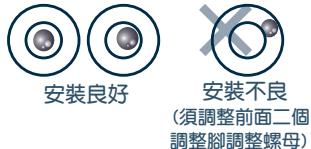
2. 水平儀氣泡位置於中心點時，請鬆開固定螺絲帽，轉動調整腳至氣泡位水平儀中心為止。
