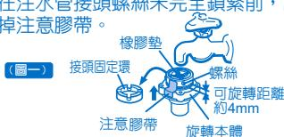
2. 依水龍頭的前端，注水管接頭移為中心，螺絲均等確實的鎖緊
