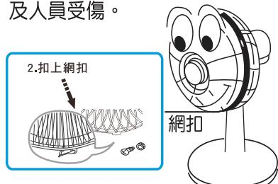
組合完成後，網扣一定要扣緊，取出附件包並確實鎖緊螺絲。(為安全一定要栓緊)
